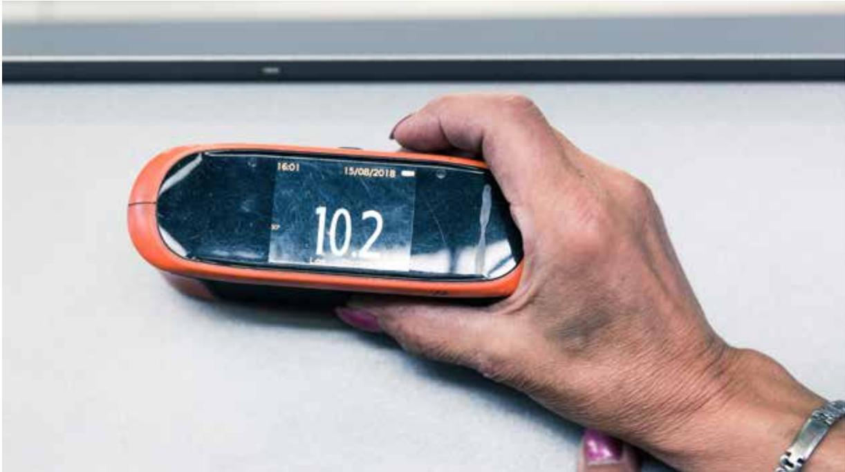
Abbildung 7: Glanzgradmessung
