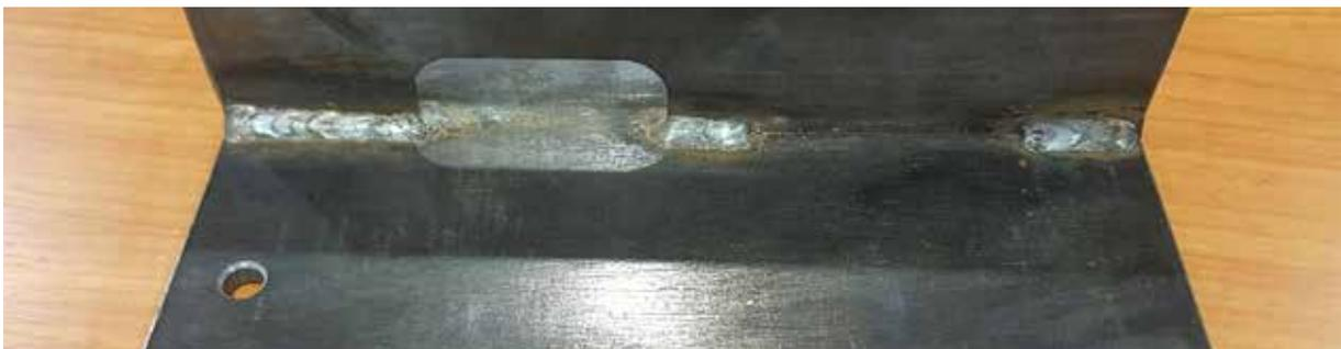
*Schweißfuß: links richtige Ausführung, rechts Korrosionsgefahr durch Spalt*
