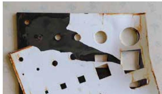
Probestück ohne Kantenverrundung; Vollenthaftung nach 250 h NSS
