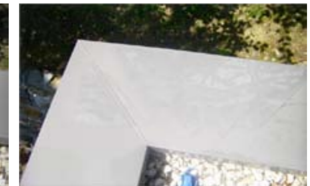
Bild 14 und 15: Fleckenbildung auf einem Aluteil durch längere Lagerung in Folie im Freien
